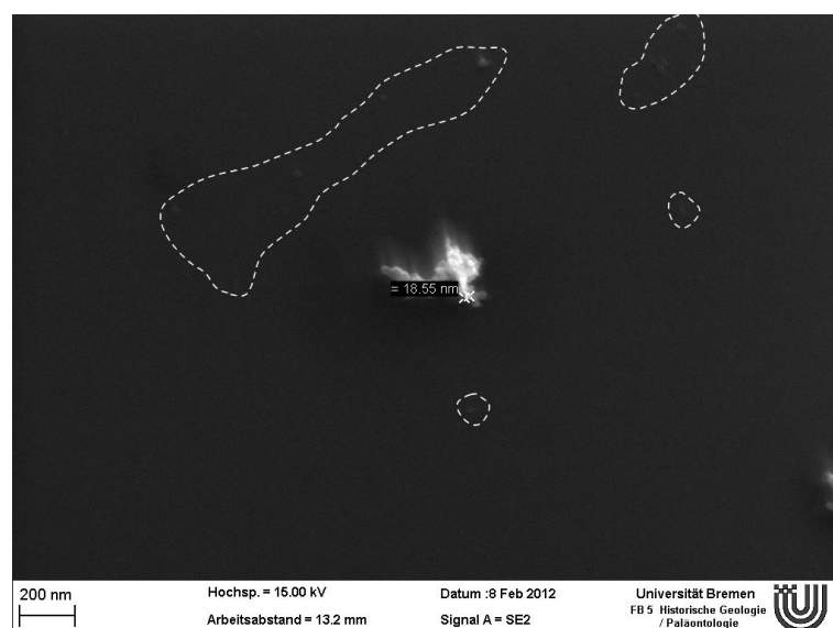
Abb. 24b: Abmessung der Primärpartikel eines \text{TiO}_2 -Agglomerats (REM-Aufnahme, 100.000x). In den gekennzeichneten Bereichen sind Einzelpartikel erkennbar – niedrige Konzentration, mit Auflader, 60 min. Messzeit
